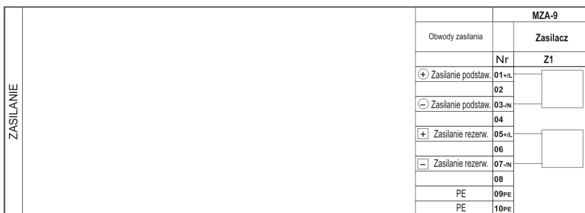
Rys. 5.1. Schemat połączeń modułu zasilania MZA-9.
