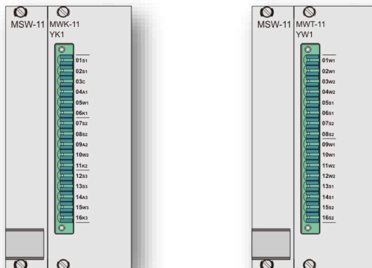
Rys. 5.26. Widok dostępnej dla użytkownika strony modułów wyłączników pofazowych MKW-11 i trójfazowych MWT-11 wraz z modułem sterującym MSW-11.
