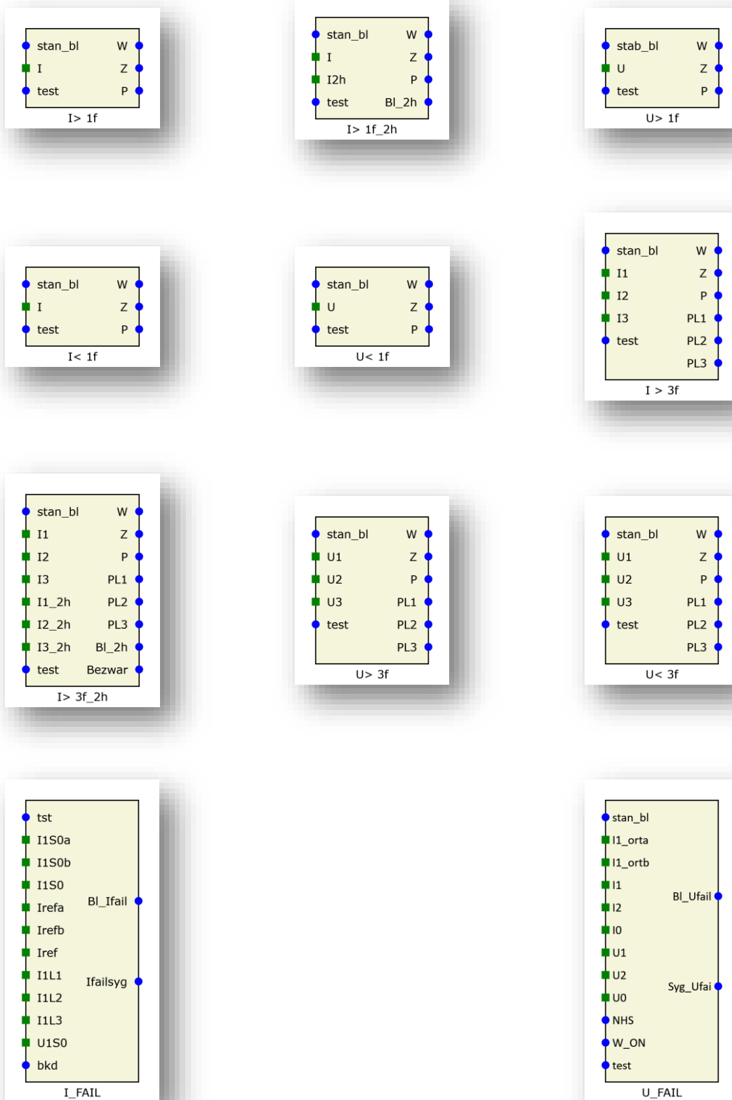
Rys. 9.48. Bloki logiczne dla grupy „f.zabezpieczeniowe” cz. 1.
