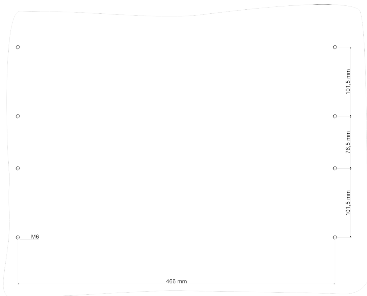
Rys. 11.6. Wytyczne montażowe urządzenia natablicowego o wysokości 8U.
