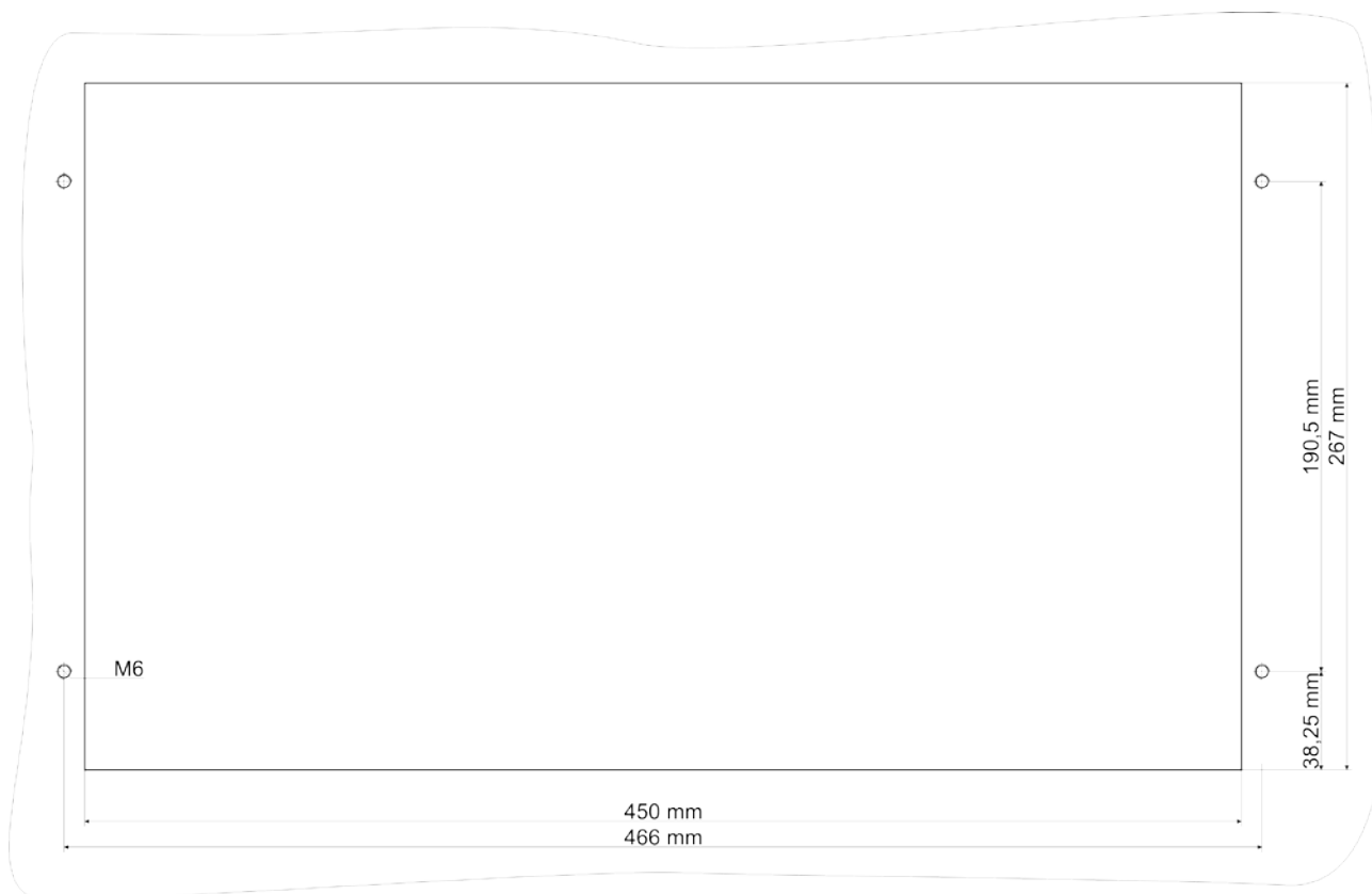
Rys. 11.4. Wytyczne montażowe urządzenia zatablicowego o wysokości 6U.
