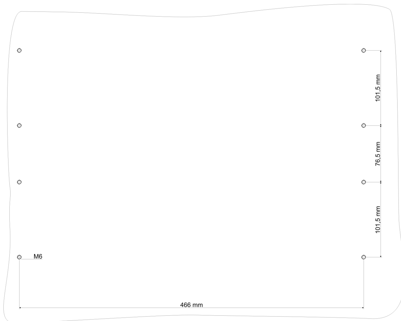
Rys. 11.6. Wytyczne montażowe urządzenia natablicowego o wysokości 8U.
