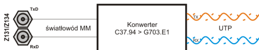
Rys. 5.33. Telekomunikacja w protokole G703.E1 za pomocą konwertera.
