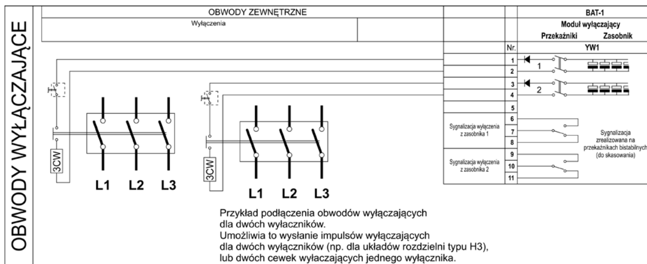
Rys. 3.4. Obwody wyłączające dwóch niezależnych wyłączników.
