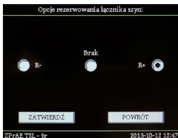
Rys. 11.8. Rezerwowanie pola sposób nr 1 (dla JP w wersji F lub FA) - ustawienia na wyświetlaczu
