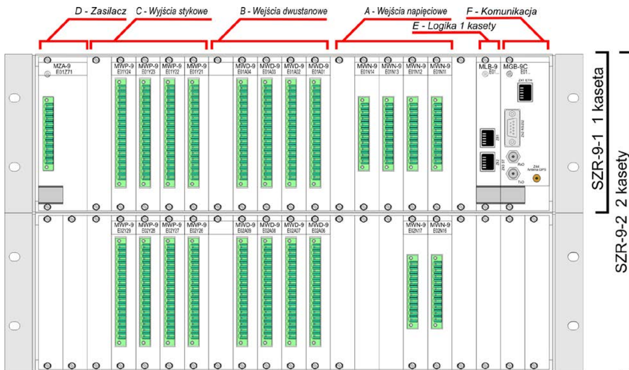
Rys. 4.3. Płyta tylna przełącznika SZR-9
