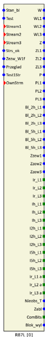
Rys. 8.80. Blok logiczny funkcji R87L
