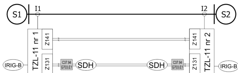
Rys. 8.103. Topologia połączeń dwóch terminali za pomocą łącz telekomunikacyjnych.
