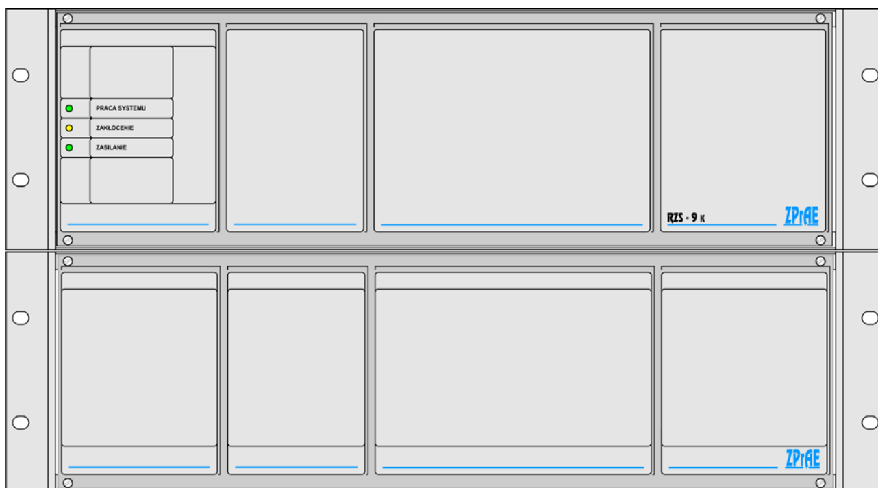
Rys. 3.20. Płyta przednia kasety RZS-9k – 6U.
