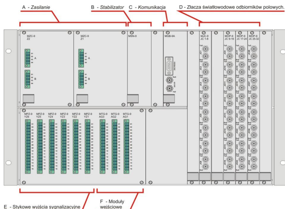
Rys. 4.15. Rozmieszczenie złącz na tylnej płycie jednostki centralnej TSL-9r JC
