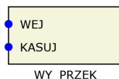
Rys. 6.37. Widok bloku wyjścia binarnego WY_PRZEK.
