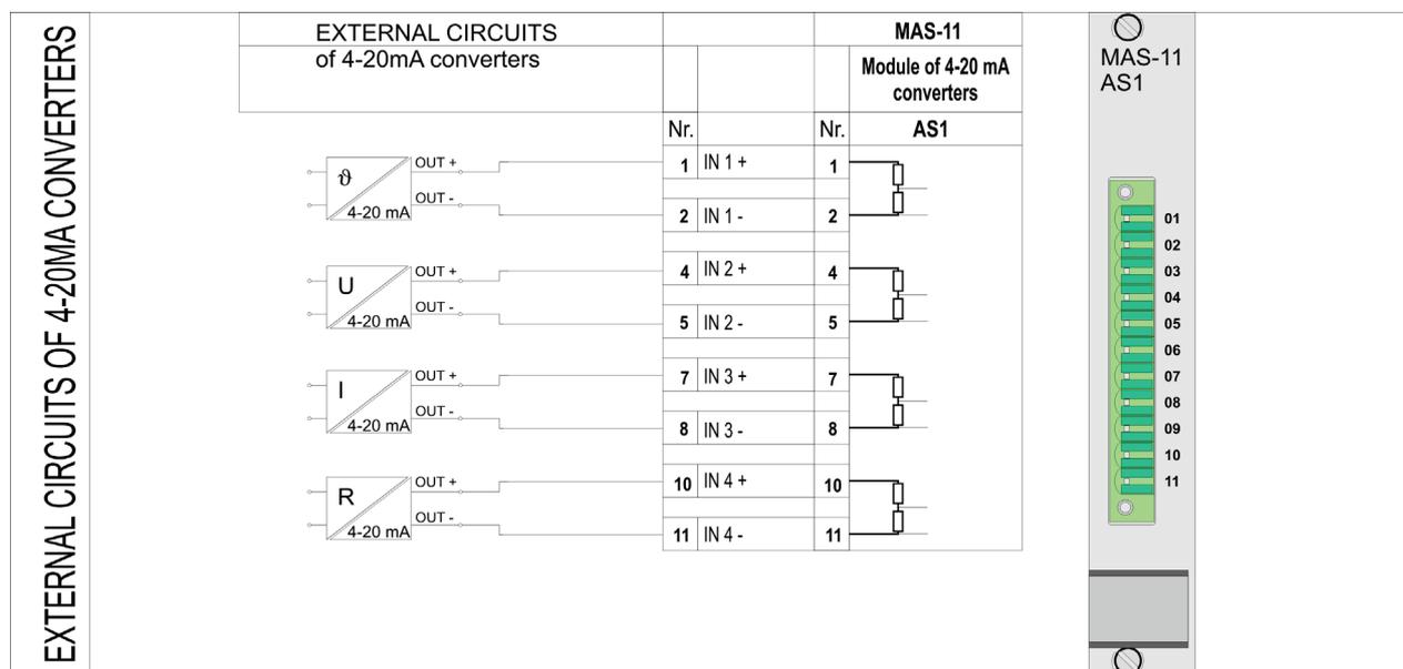
Fig. 3.4. Converters circuits 4-20mA.
