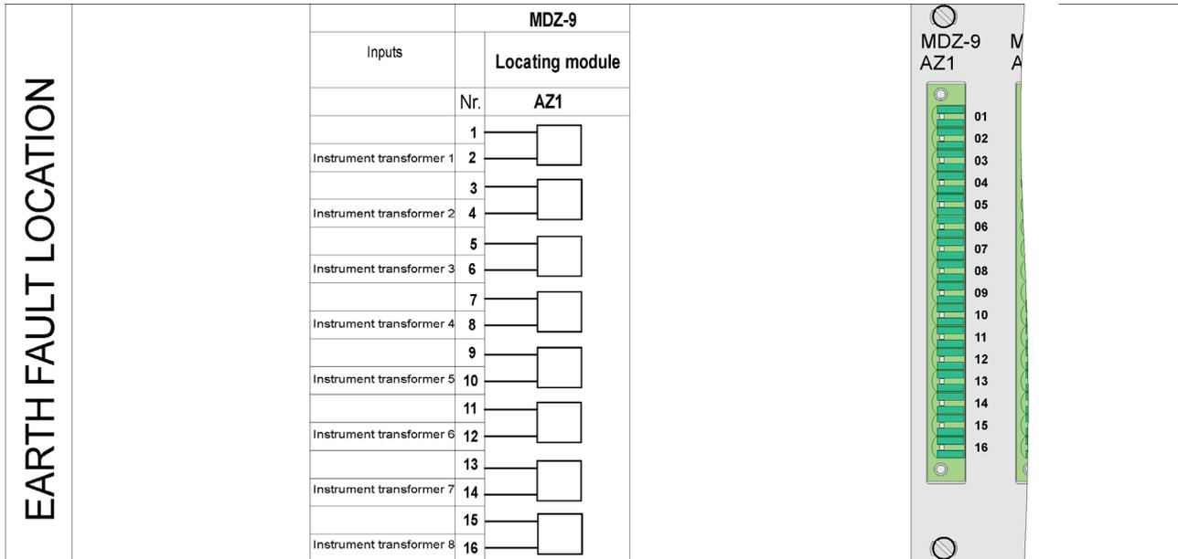
Fig. 4.4.9. MDZ-9 module inputs.
