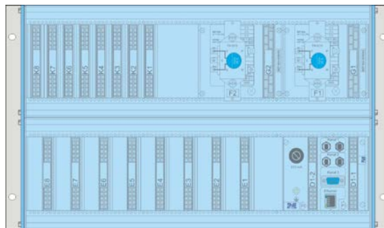
Rys. 4. Wygląd tylnej osłony kasety RFQ-8.
