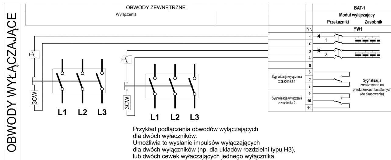
Rys. 3.4. Obwody wyłączające dwóch niezależnych wyłączników.
