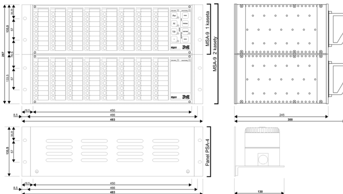
Rys. 4.1. Wymiary zewnętrzne układu sygnalizacji MSA-9 i PSA-4.
