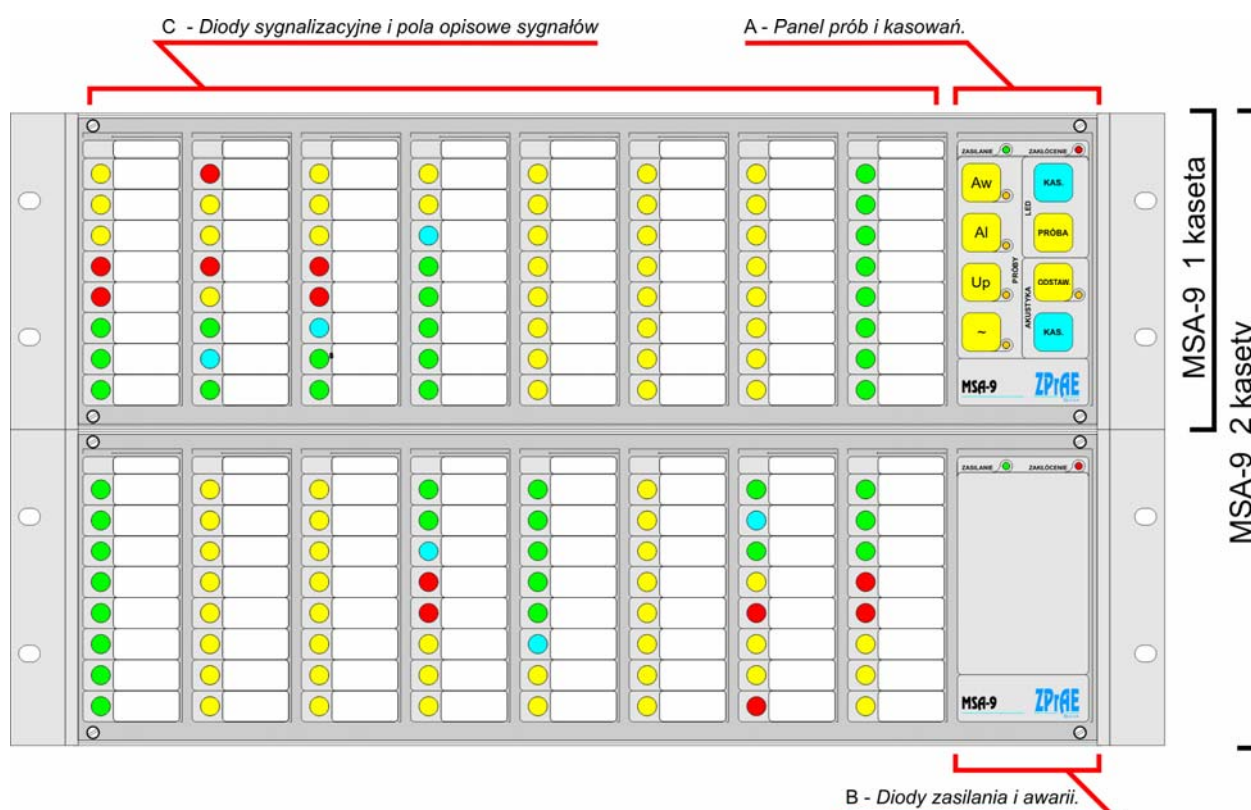
Rys. 4.2. Płyta czołowa układu sygnalizacji MSA-9.
